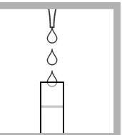
3. Adicione 8 gotas de solução indicadora de pH de azul de bromotimol no segundo tubo.
