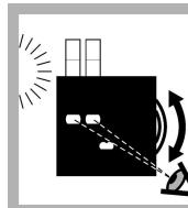
6. Coloque a caixa de comparação de cor na frente de uma fonte de luz. Vire o disco de cor para verificar a correspondência de cor.
