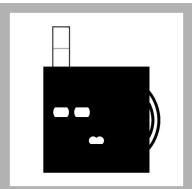
2. Insira um tubo na abertura esquerda da caixa de comparação de cor.
